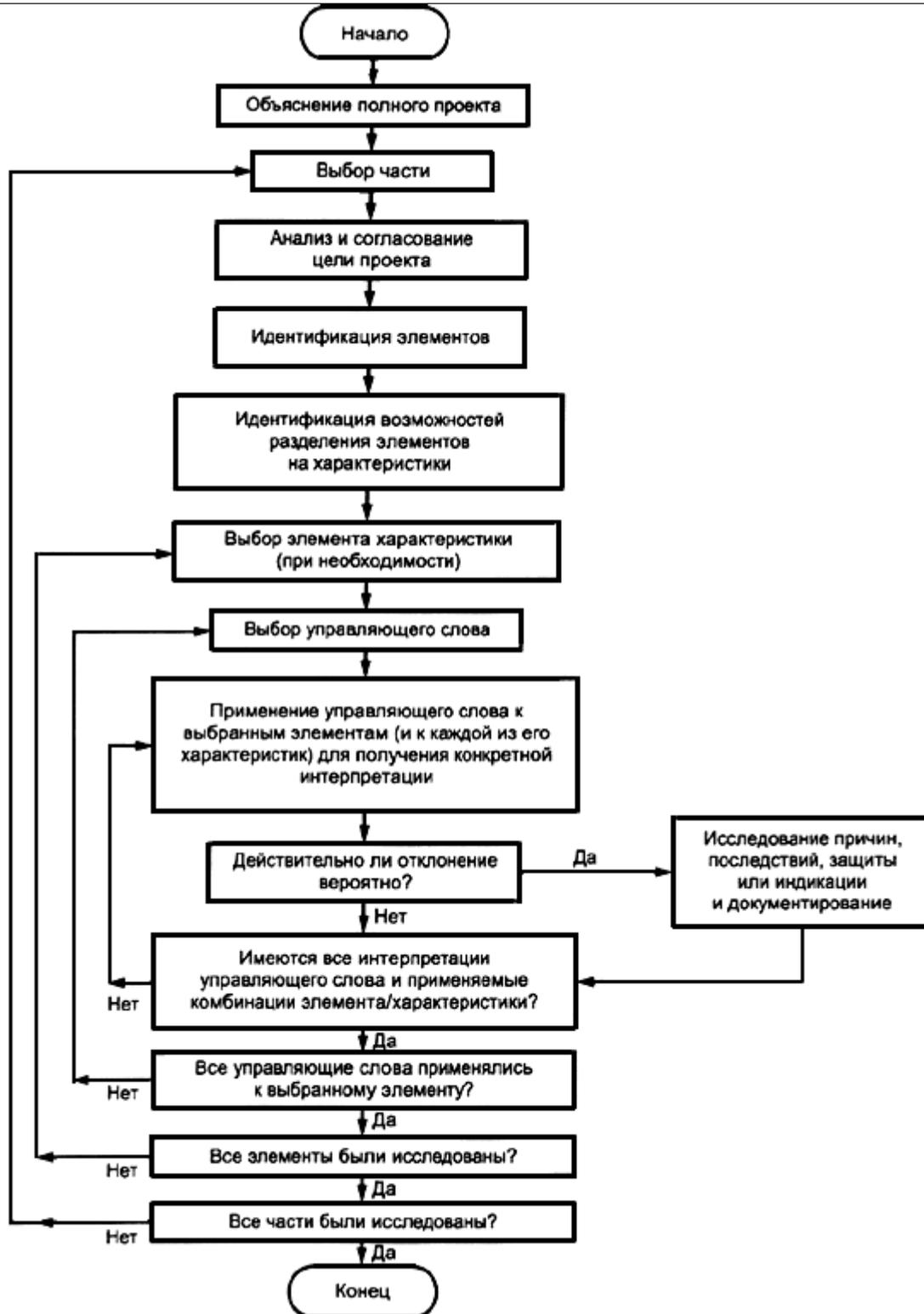
Рисунок 2а - Процедуры экспертизы HAZOP "сначала элемент"
