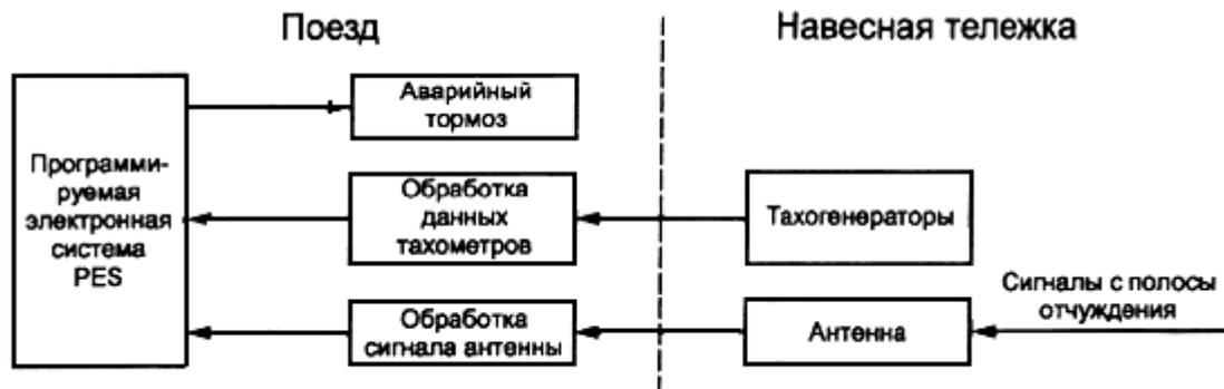
Рисунок В.2 - Блок-схема системы ATP
