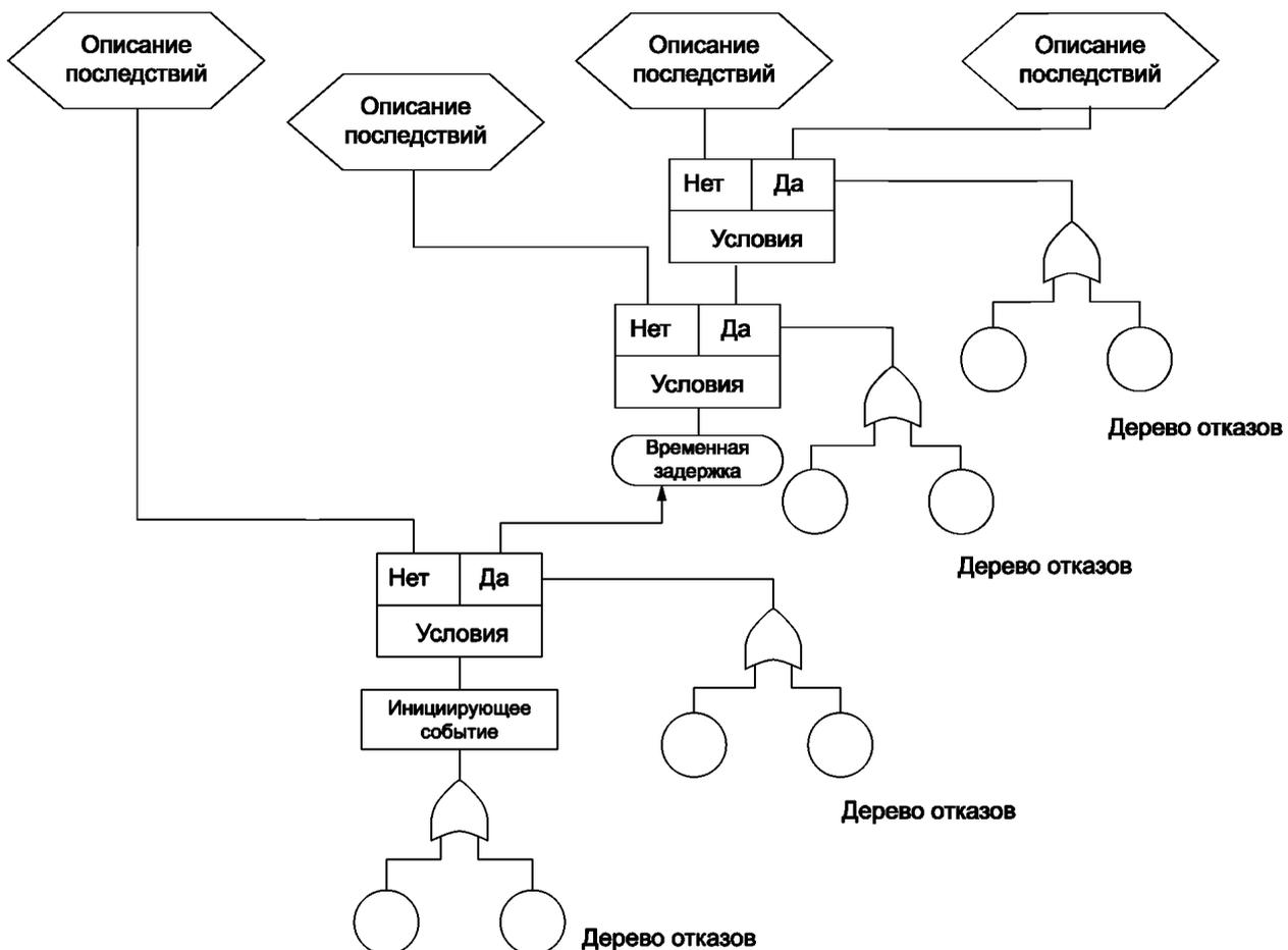
Рисунок Б.6 — Пример диаграммы причинно-следственных связей
