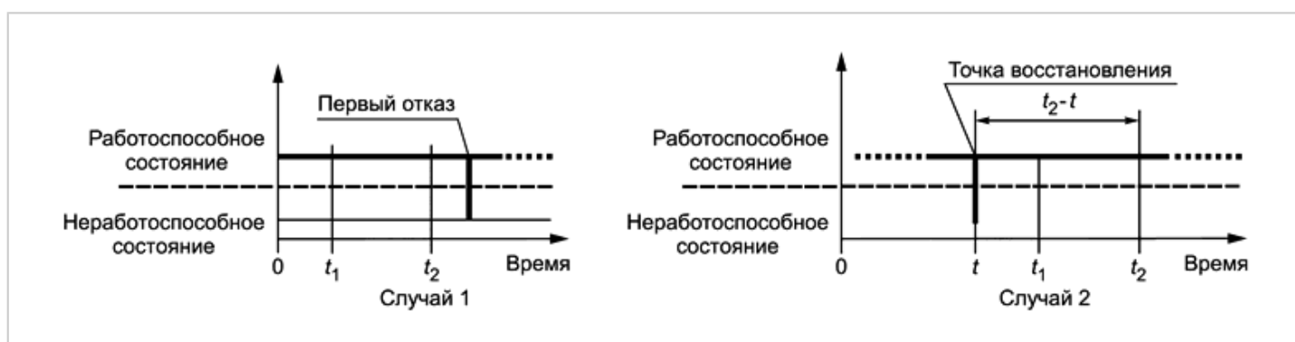
Рисунок 32 - Пример изменения вероятности безотказной работы за период времени [t_1, t_2] для нулевого времени восстановления элемента
