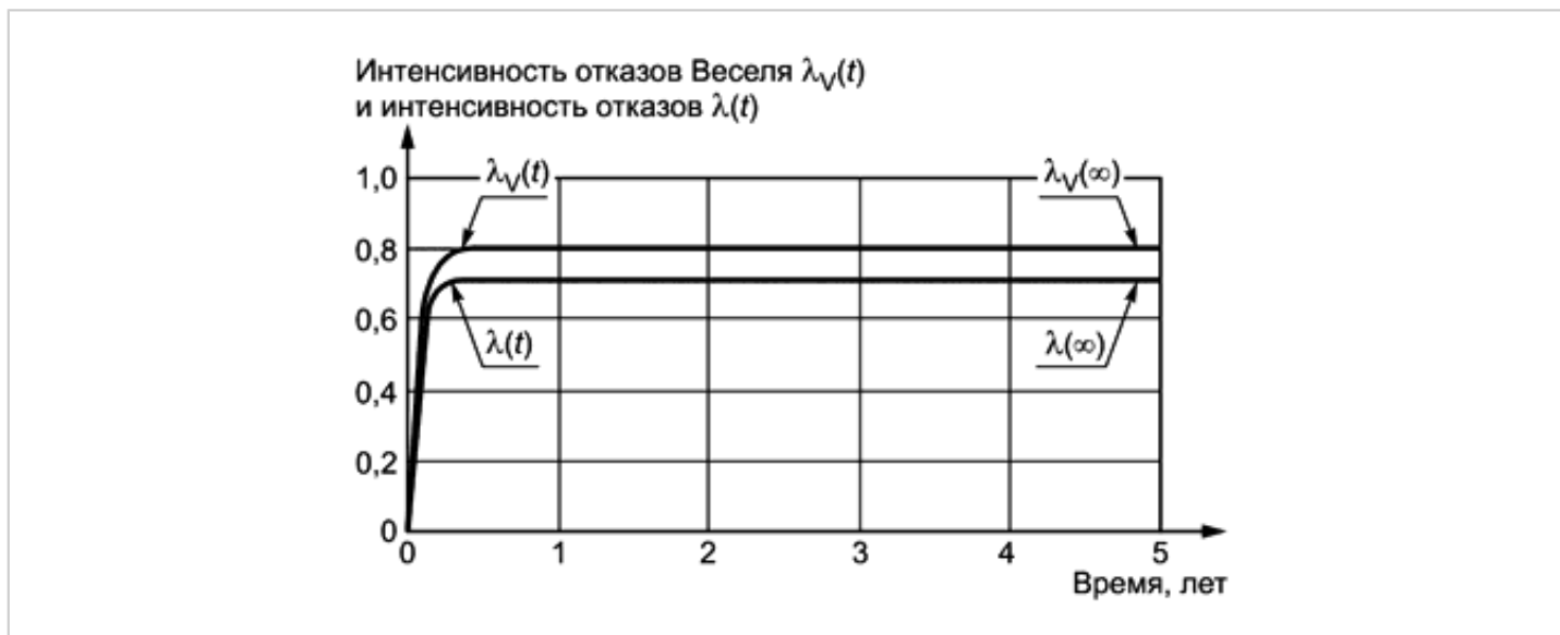
Рисунок 29 - График зависимости от времени \lambda(t) и \lambda_V(t) в случае модели, представленной на рисунке 24
