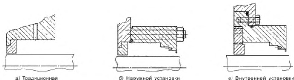
Рисунок 12 — Типы камер уплотнения
