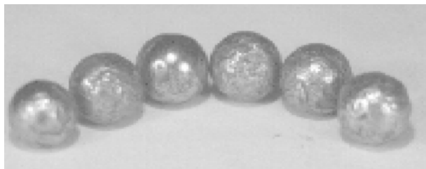
Рис. 3.15. Осповидный износ тел качения
