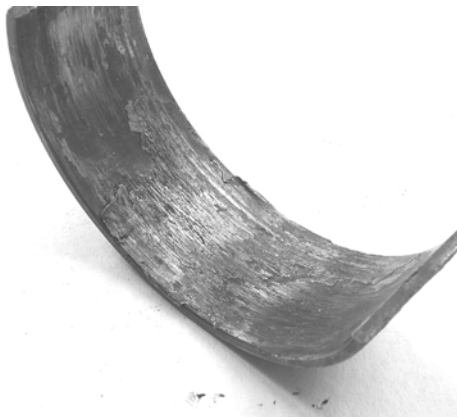
Рис. 3.3. Вид поверхности при износе схватыванием второго рода
