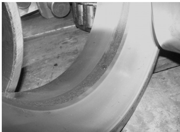
Рис. 3.17. Окислительный износ беговых дорожек конического роликоподшипника
