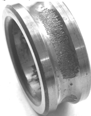
Рис. 3.12. Местное выкрашивание внутреннего кольца при вращающейся радиальной силе и неподвижном наружном кольце
