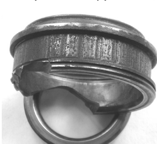
Рис. 3.11. Местное изнашивание внутреннего кольца при колебательном движении подшипника
