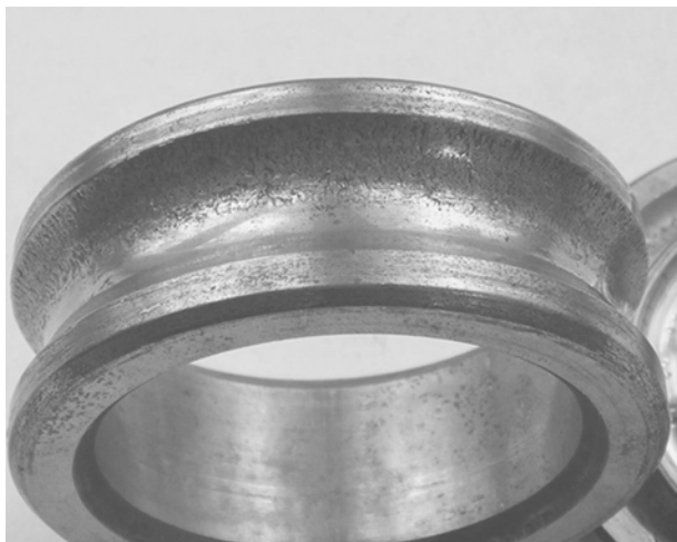
Рис. 3.13. Смещение следов изнашивания на внутреннем кольце при воздействии осевой силы
