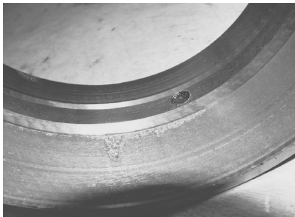
Рис. 3.16. Абразивный износ рабочей поверхности кольца подшипника
